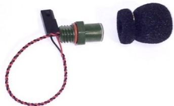
4. Afloje el micrófono desde fuera, girándolo  $\curvearrowright$  en el sentido contrario a las agujas del reloj. Si el micrófono está demasiado apretado para aflojarlo a mano, puede usar una llave de 5/8 pulgadas. Extraiga el micrófono (izquierda).
