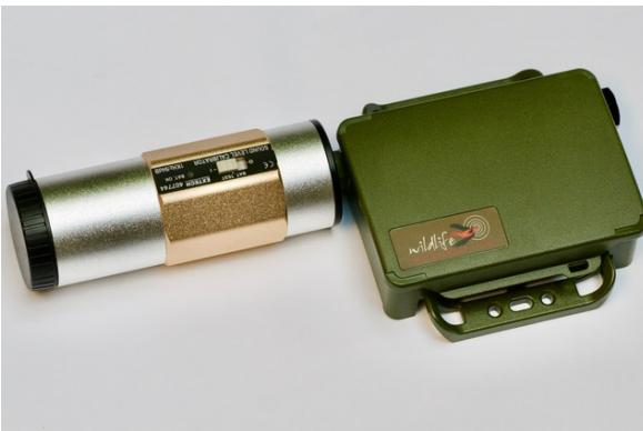
9. El calibrador genera un tono de 1 kHz.
