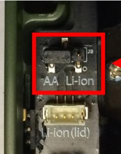
Conexión de la fuente de alimentación mediante conector de tres terminales montado en la configuración estándar para utilizar pilas AA
