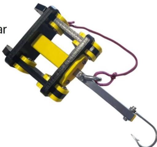
Un retroceso del ROV permite fijar el anzuelo y, a continuación, soltarlo para separarlo del ROV mientras se mantiene unido a la línea de superficie.
