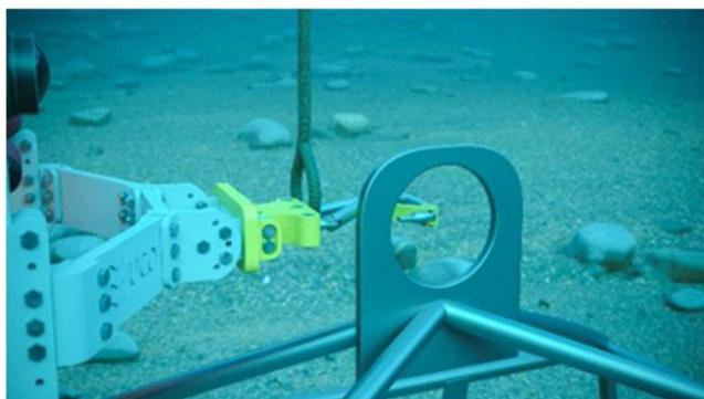
Basta con enganchar el elemento deseado, empujar hacia atrás para liberar el seguro y fijar el mosquetón. Un empujón adicional liberará el mosquetón de la estructura del ROV.
